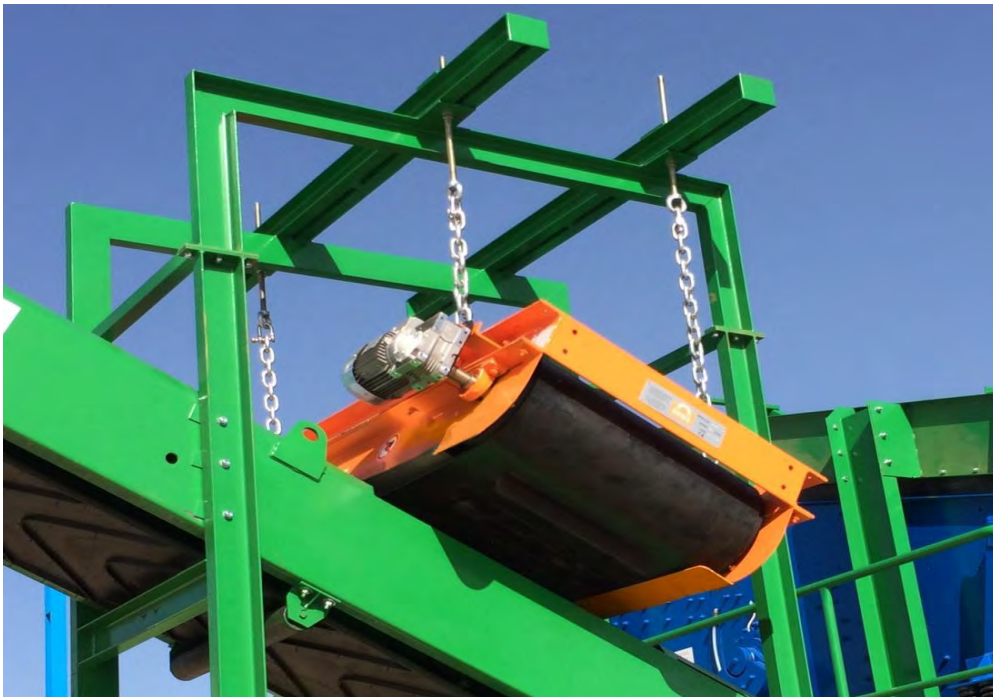
Instalare tipică (lanțurile nu fac parte din oferta Eriez)
